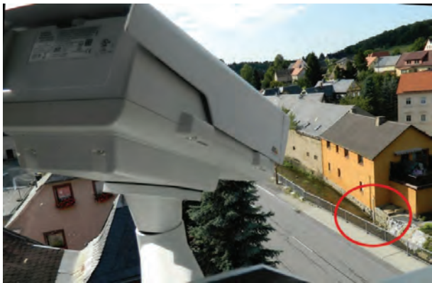
Kamera auf dem Schlauchturm mit Blick auf den Pegel (roter Kreis)
