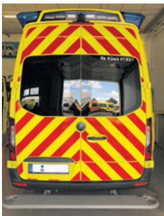
So sehen Sie aus, die neuen Fahrzeuge des Rettungsdienstes. Sie sind sowohl an den Seiten als auch im Vorder- und Rückbereich rot-gelb markiert. Die reflektierende Warnmarkierung im Front- und Heckbereich dient der Sicherheit und besseren Sichtbarkeit im Einsatz.
