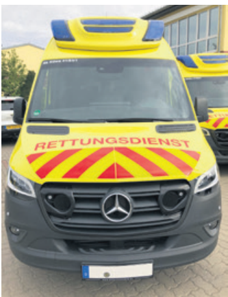
So sehen Sie aus, die neuen Fahrzeuge des Rettungsdienstes. Sie sind sowohl an den Seiten als auch im Vorder- und Rückbereich rot-gelb markiert. Die reflektierende Warnmarkierung im Front- und Heckbereich dient der Sicherheit und besseren Sichtbarkeit im Einsatz.
